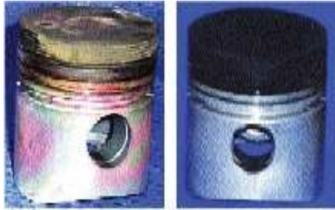
Abbildung 5: Vergleich beschichteter und unbeschichteter Kolben
